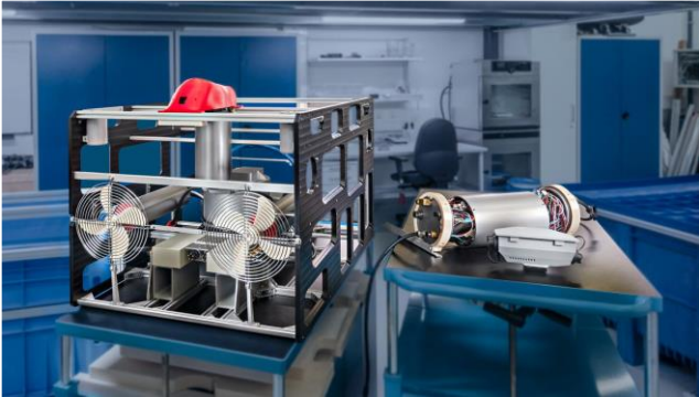
DEDAVE Tiefenautonomes, autonomes Unterwasserfahrzeug für vielfältige Explorations- und Inspektionsaufgaben.
