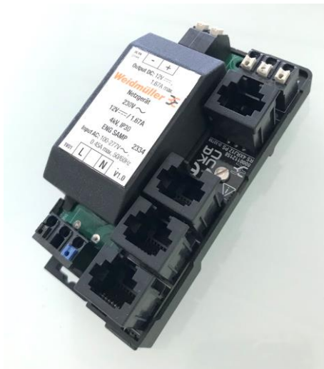
LMN Verteiler aktiv mit 12 V Netzgerät
